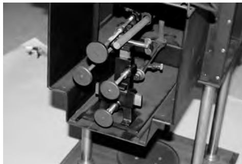
Figura 7. Detall de la regulació dels carbons.
